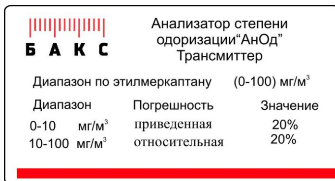
Рис. 6. Табличка с метрологическими характеристиками анализатора
