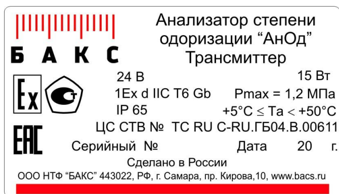
Рис. 5. Табличка, установленная на корпусе анализатора
