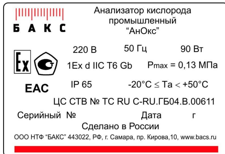
Рис 7. Табличка, установленная на крышке анализатора кислорода
