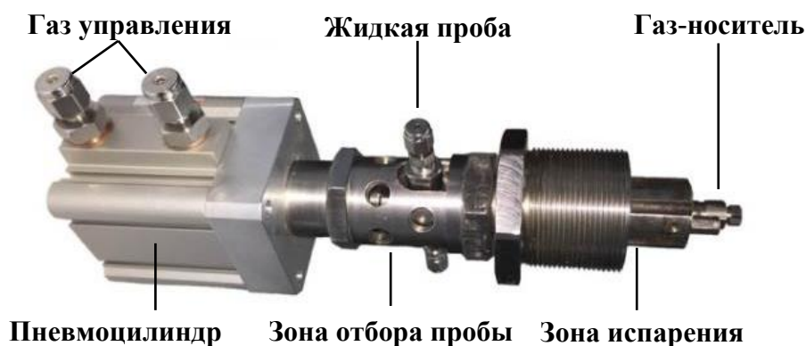
Рисунок 10. Инжектор-испаритель для хроматографа МАГ
