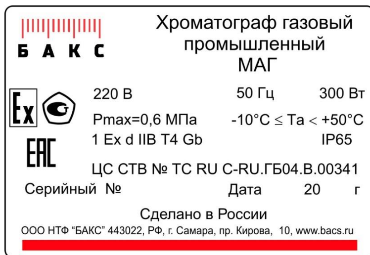
Рисунок 15. Маркировочная табличка хроматографа МАГ
